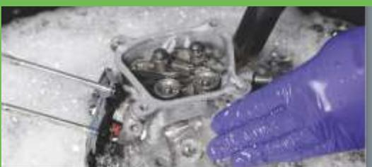
Durch die 42 °C warme Reinigungsflüssigkeit werden die Mikroben aktiv. Öle und Fette werden in CO<sup>2</sup> und Wasser umgewandelt und die Reinigungsflüssigkeit bleibt sauber und leistungsstark.
